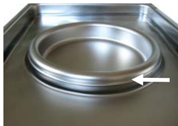
Abbildung 11: Füllhöhe der äußeren Wasserschale für Gerätegröße 170 / 260
