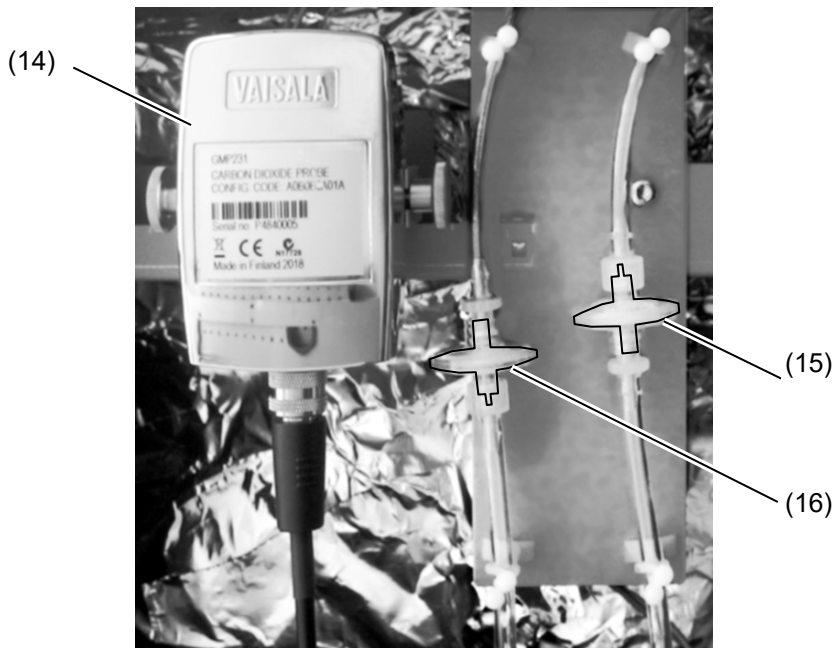
Abbildung 41: Position des CO 2 Sensors und der Gas-Feinfilter hinter der Abdeckung
